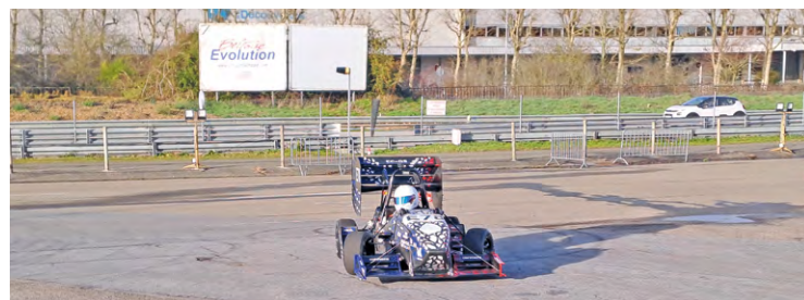
La monoplace EC-05, la 1 re 100% électrique de l'Estaca formula team, peut circuler à une vitesse maximale 110 km/h et est dotée d'une batterie de 80 kW/h maximum.
