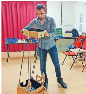
Voici un télescope Strock-250 mm de voyage, entièrement démontable pour être transporté en bagage cabine.
